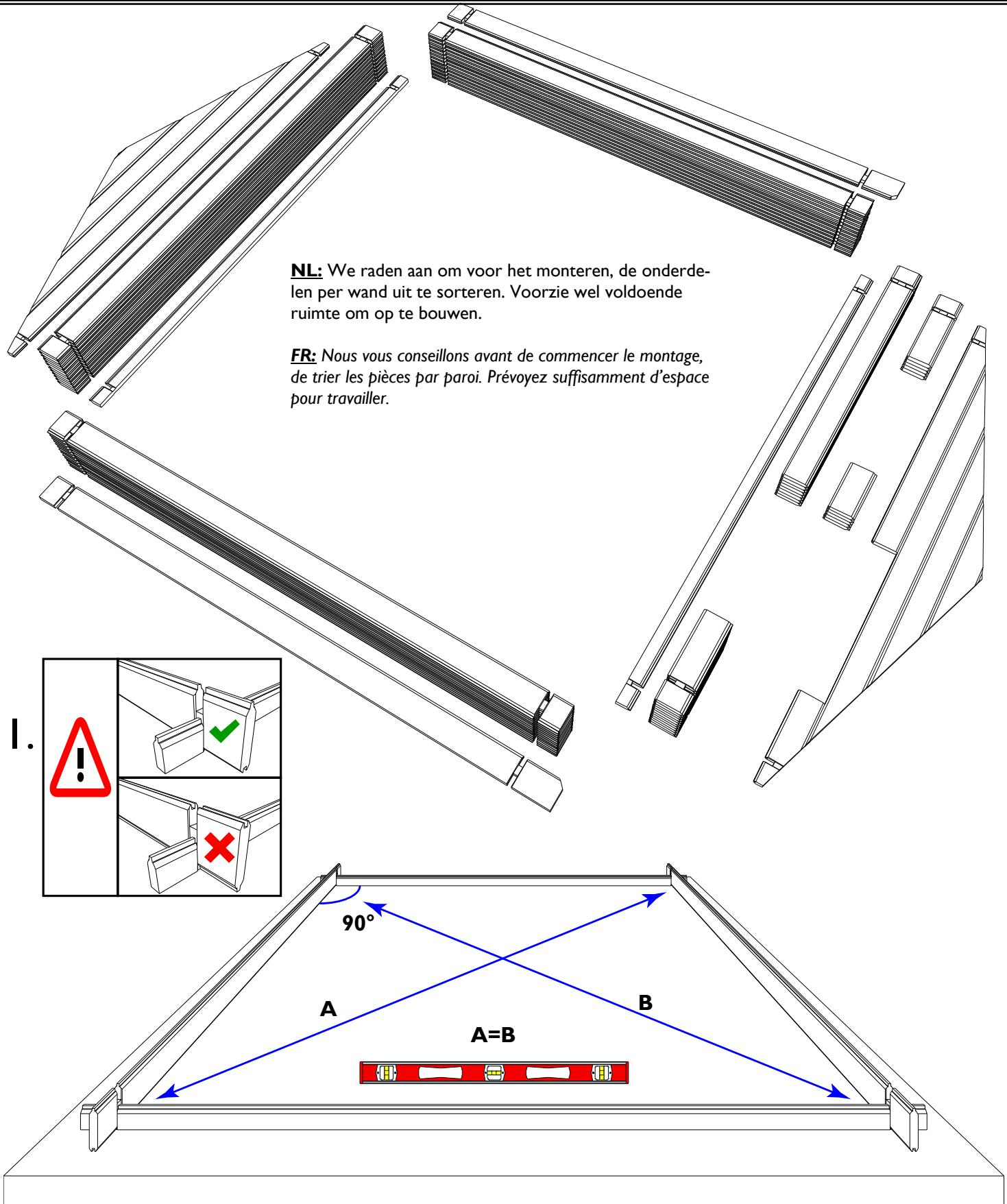
**2.** **NL:** Indien bij het model de deur niet in het midden zit kan u kiezen aan welke kant u de deur plaatst. **Opgelet:** monter eerst de **hoekijzers**, dan pas **zagen**. Het stuk dat u wegzaagt is afval. Montere dit zeker **nooit** boven de deur! Raadpleeg voor de verdere opbouw ook de plannetjes van de wanden uit de onderdelenlijst.
