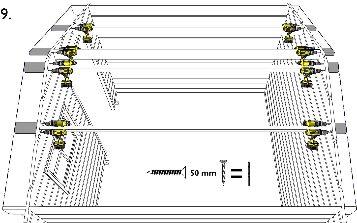
**10.** **NL:** Plaats de platen zodanig dat de buitenste golf **zonder** doek de golf van de vorige plaat overlapt. Om straks de plaatsing van de schroeven te vergemakkelijken, brengt u best een potloodstreep aan waar de dakbalken zich bevinden. **Opgelet!** Bevestig de platen nog niet. Plaats eerst alle platen zodat u nog eventuele aanpassingen kan uitvoeren.
